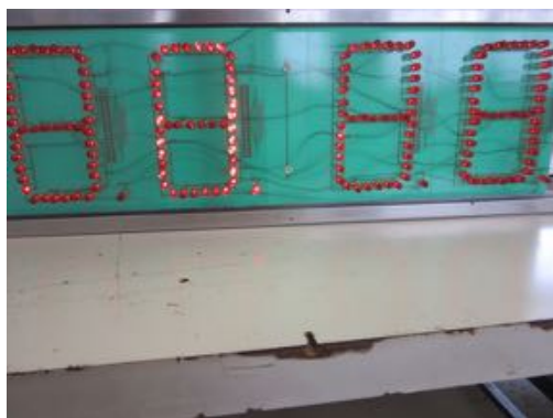
1. LEDを使用したビッグクロック製作
