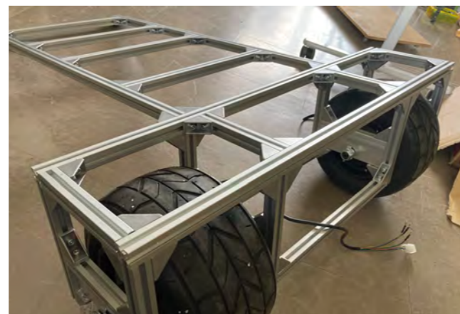
▲インホイールモータ仕様電動バギー
