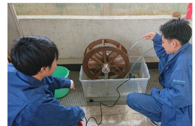
▲水力発電装置
