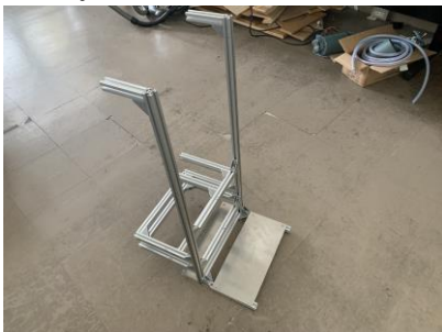
図4 昇降機の組み立て
