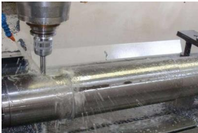
図4 油を流すキー溝加工の様子 加工する際に熱が発生してしまうため油を流すことで、素材を冷やしながら加工することができる。
