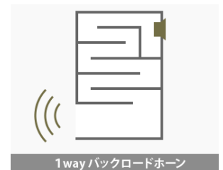
図2 バックロード型内部
